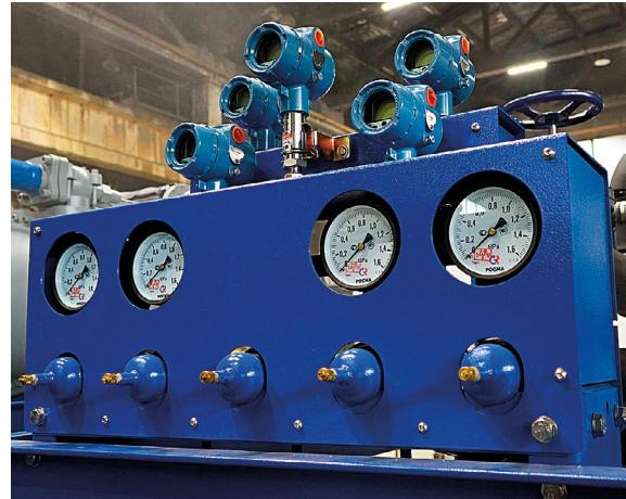
Холодильная установка работает двумя независимыми холодильными контурами в одноступенчатом холодильном цикле.
